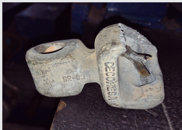
Muestra al término del ensayo de resistencia a la tensión debido al fallo del elemento (M1).
